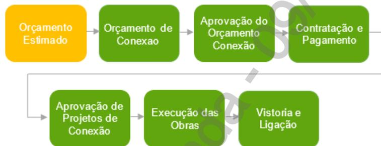
**Figura 01 - Etapas para Conexão de Centrais Geradoras**
