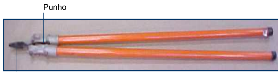
Alicate sem isolamento no cabo
