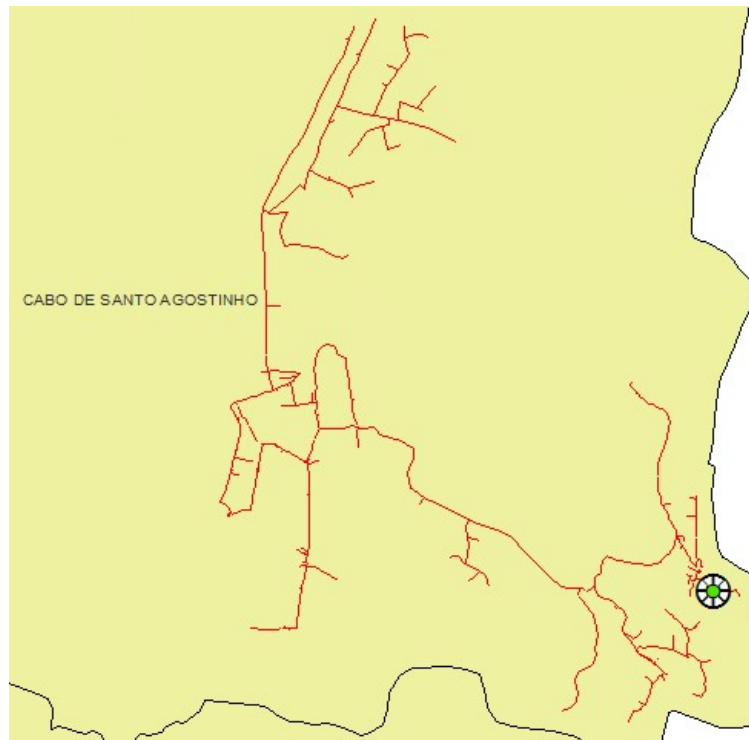
Figura 103 – Todos alimentadores do conjunto Suape que sofreram interrupções parciais.
