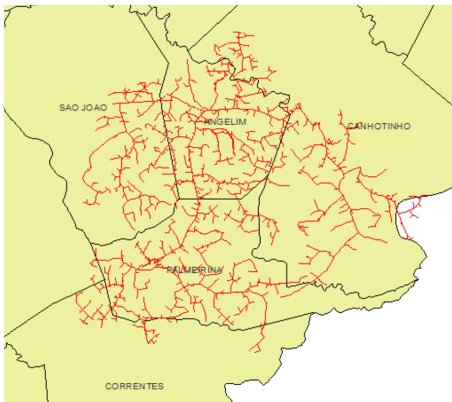
Figura 7 – Todos alimentadores do conjunto Angelim que sofreram interrupções parciais.
