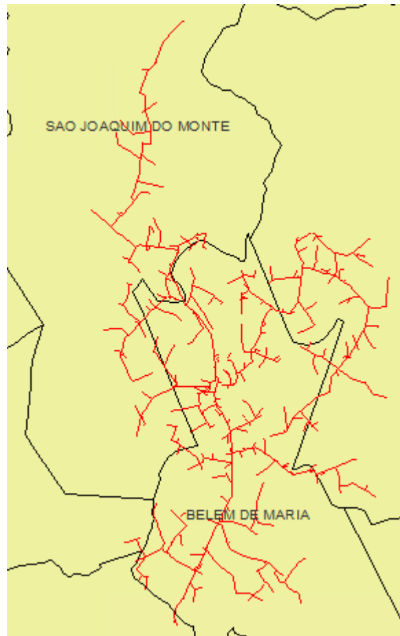
Figura 8 – Alimentador do conjunto Barragem do Prata que sofreu interrupções parciais.
