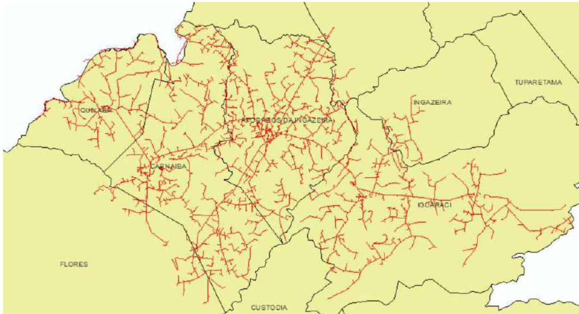
Figura 4 – Todos alimentadores do conjunto Afogados da Ingazeira que sofreram interrupções parciais.
