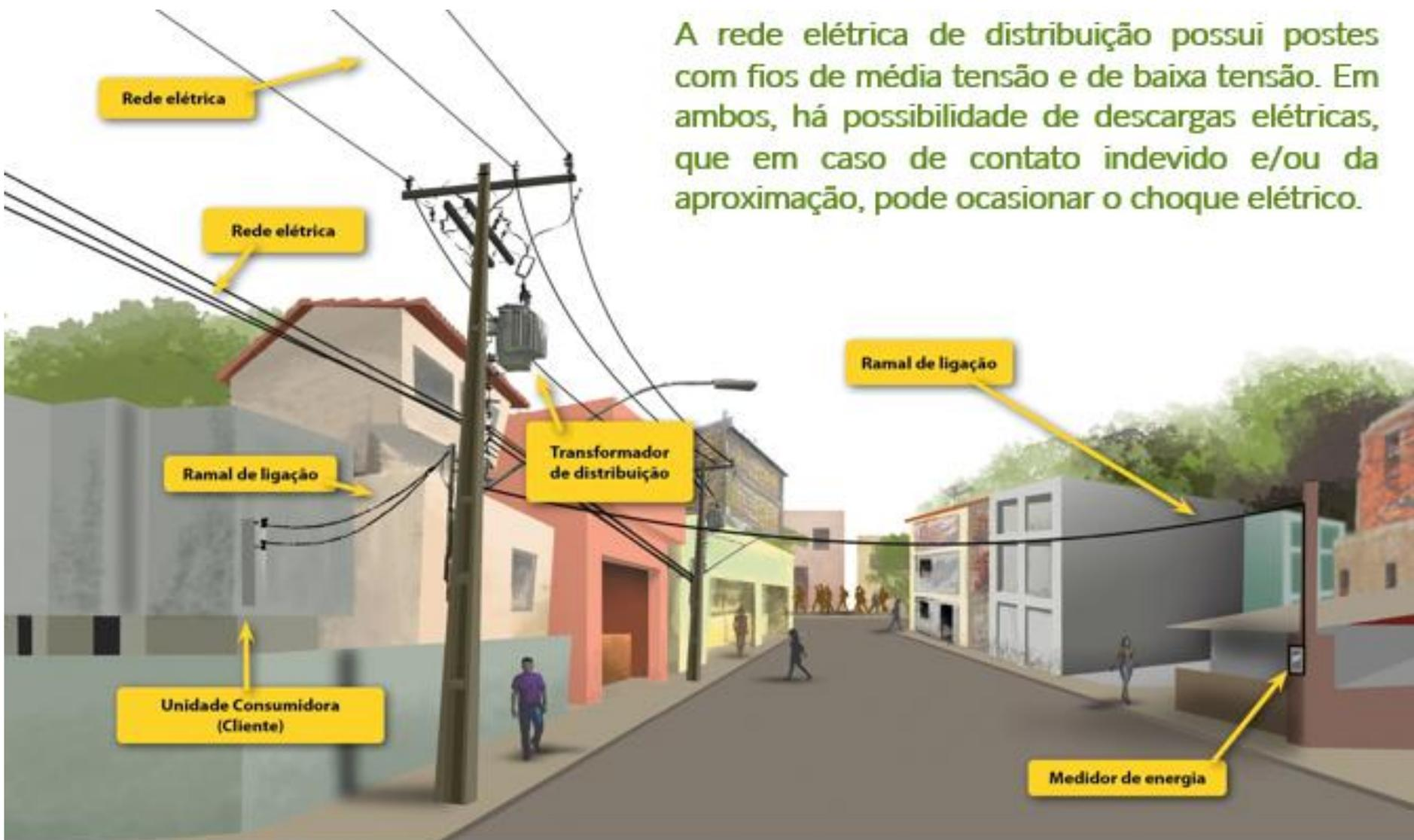
A rede elétrica de distribuição possui postes com fios de média tensão e de baixa tensão. Em ambos, há possibilidade de descargas elétricas, que em caso de contato indevido e/ou da aproximação, pode ocasionar o choque elétrico.
