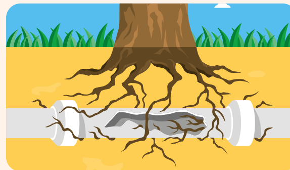
A escolha do local é importante, para que não haja interferência das raízes nas tubulações existentes
