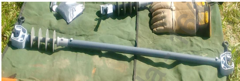
Figura 02 – Instalação da garra sem isolador com pino travante
