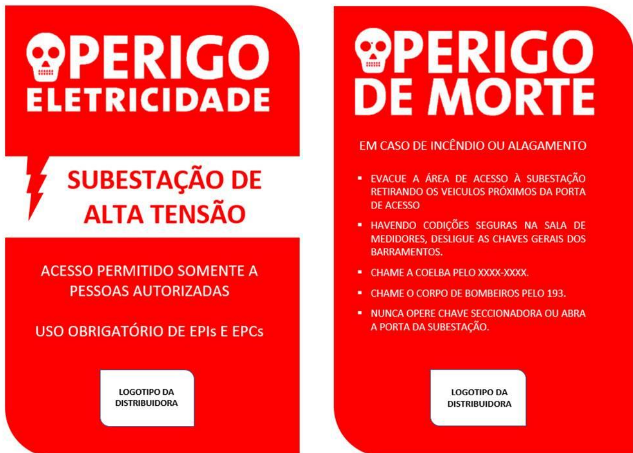
Figura 2 – Adesivos para Portas das Câmaras de Transformação
