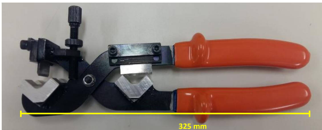
Foto Ilustrativa – Decapador (medidas em milímetros)
