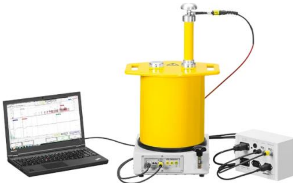
4 - Equipamento para medição de Descargas Parciais offline
