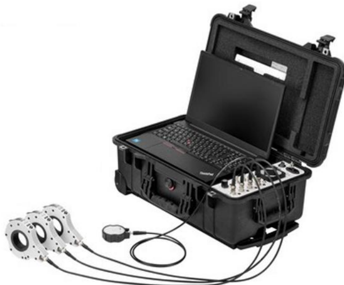
1 - Equipamento para medição de Descargas Parciais online
