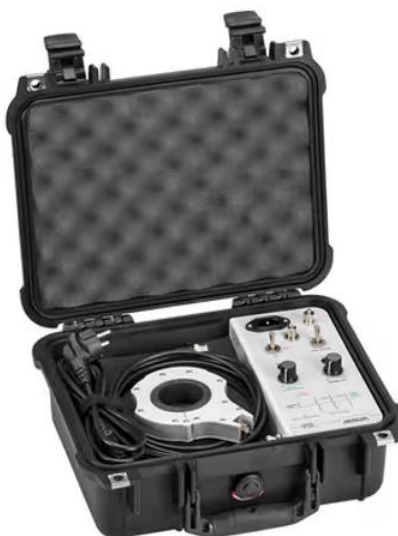
2 - Equipamento para localização de Descargas Parciais online
