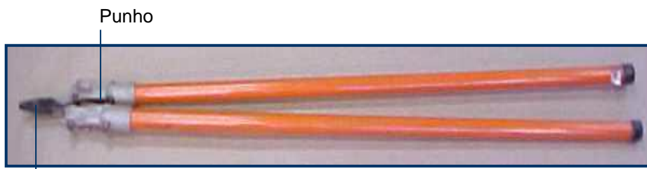
Alicate sem isolamento no cabo
