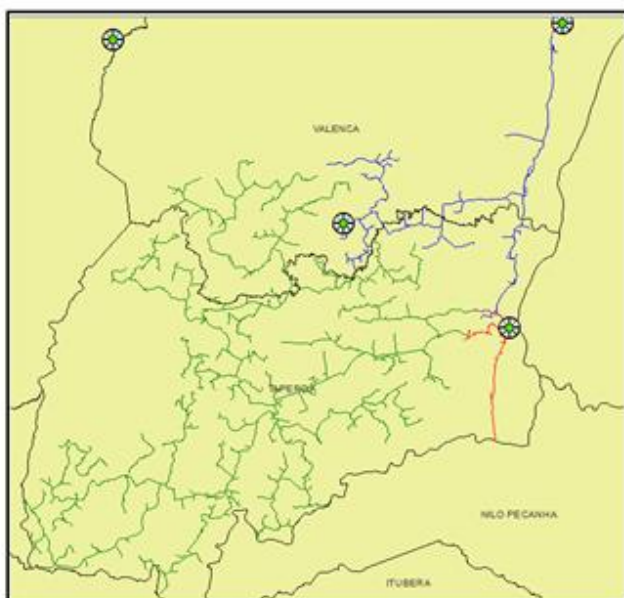
Alimentadores da Subestação TPA
